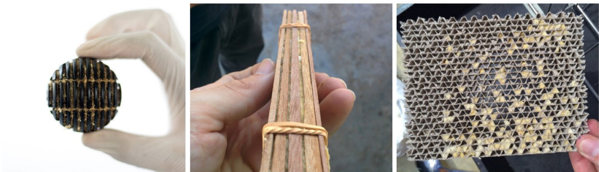
Figuur 1 Verschillende varianten van eggies: "Bioballen", meestal gebruikt als filtermedium in aquaria en vijvers (links), stapeling van houten platen met een kleine tussenruimte (midden), en kartonnen honingraat (rechts)
